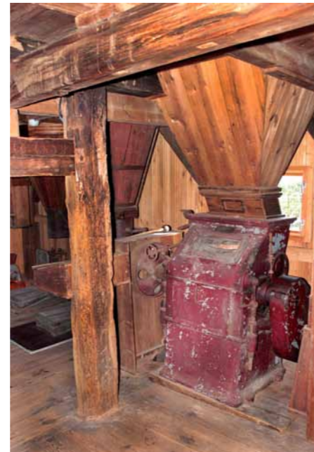
Walzenstuhl auf dem Mahlboden der Hornower Mühle, (Foto: Rüdinger)
